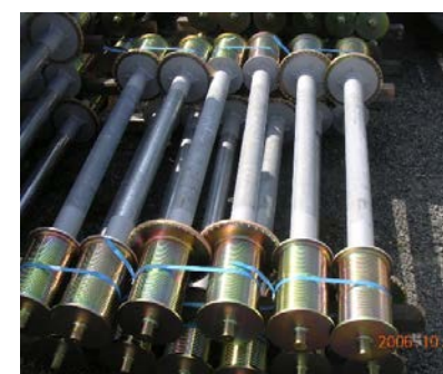
立体駐車場巻ドラム
